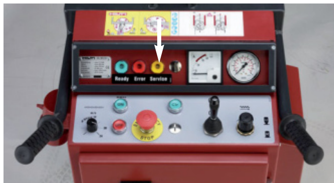
10.19 Возможно, не работают служебные индикаторные лампочки и узел привода
